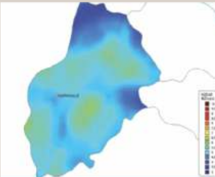
■ Yer seviyesinden 50 m yükseklik için beklenen ortalama rüzgar hızlarını gösterir Kırıkkale rüzgar potansiyel atlası.
